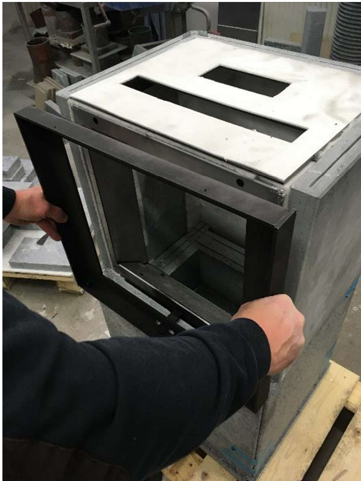
Install door frame
