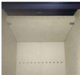
7. Encajar el deflector en su posición. Verificar el soporte del separador (izquierdo y derecho).
