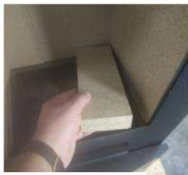
7. Encajar el deflector en su posición. Verificar el soporte del separador (izquierdo y derecho).
