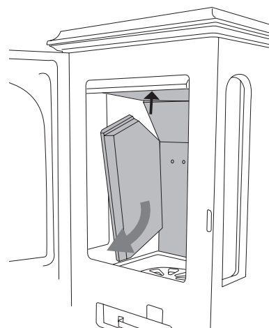
2. Luego retira el ladrillo lateral grande levantando primero el ladrillo del techo que bloquea el ladrillo lateral grande
